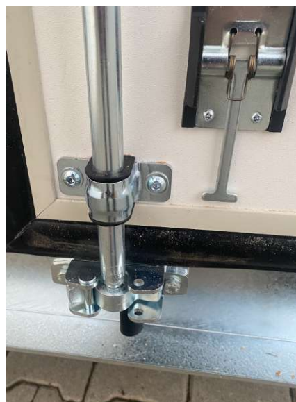
Arrêts de portes partie sur la porte
