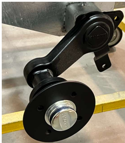
Essieu KNOTT à bras forgé beaucoup plus résistant qu'un bras en tôle soudées ou en profil.
