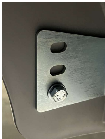
Garde boues montés indépendamment de la carrosserie avec des supports réglables en hauteur à 6 positions
