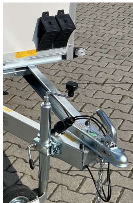
Cales de roues sur support extérieur prêtes à l'emploi à portée de main.
